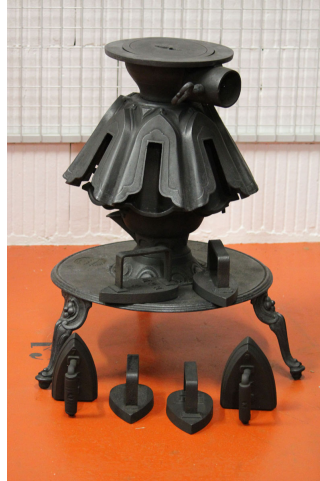
Repasseuse n° 8 Bis à enveloppes équipée de 6 fers à repasser
