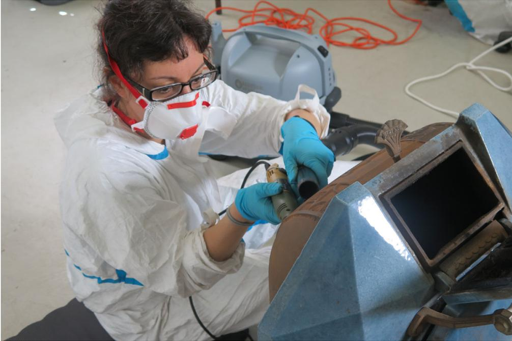
Dégagement des produits de corrosion du fer avec une brosette montée sur microtour couplé d'une aspiration. Crédit photographique : Clara Huynh, 2019.
